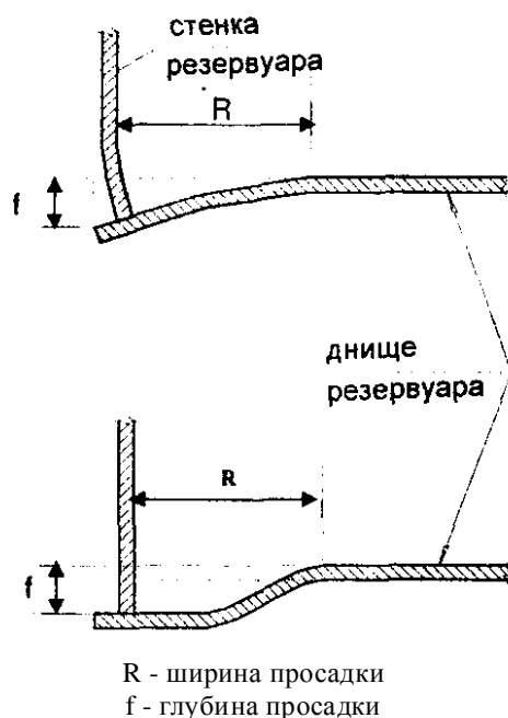
Р - ширина просадки f - глубина просадки Фиг. 5-3. Просадка края
